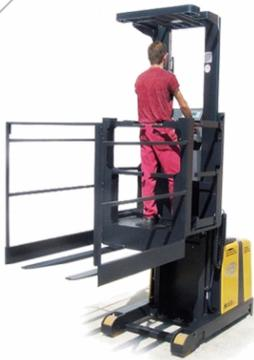
Le MAX 1 de Samag est un préparateur de commandes, disponible pour levage de 1.200 mm jusqu'à 1.800 mm depuis le pied de l'opérateur (hauteur maximale de prélèvement 3.300 mm) idéal spécialement pour des opérations rapides et confortables de prélèvement bas et moyen avec fourches fixes.
