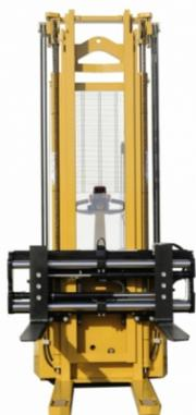
Sempre più in alto: carrello elevatore adatto per le operazioni di prelievo e deposito fino a 6.500 mm
