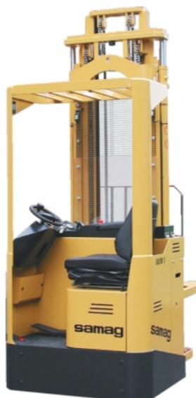
Elfo 1 è un carrello elevatore destinato a movimentare pallets fino a 6.500 mm in corridoi compatti.
