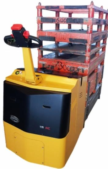
TMax 100, con portata **fino a 10000Kg**, è il carrello trasportatore ideale per chi lavora con carichi molto pesanti in spazi ristretti. Lo sterzo elettrico, il timone e il gruppo di trazione centrali permettono un'eccellente **ergonomia di guida, sicurezza** e un'ottima **manovrabilità** del carrello.
