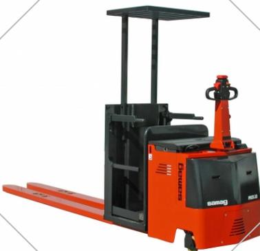
Pick 20 e Pick 22 di Samag sono i carrelli commissionatori ideali per il trasferimento delle merci fra i vari reparti ed operazioni di basso e medio picking. Per ottimizzare le operazioni di picking si possono allestire i carrelli con la Pedana Elevabile (serie PICK PE) che può raggiungere l'altezza di 1180 mm da terra e quindi permettere all'operatore di prelevare merce a circa 2700 mm da terra.
