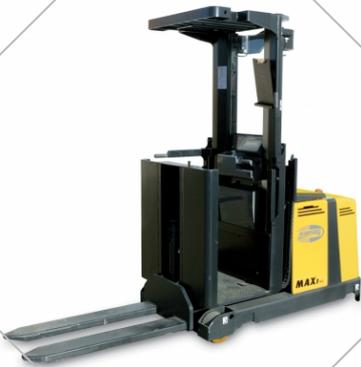
MAX 1-L di Samag è un carrello commissionatore, disponibile con elevazioni da 1.200 mm fino a 1.800 mm piede operatore (massima altezza di prelievo 3300 mm) particolarmente adatto per operazioni veloci e confortevoli di basso e medio picking con livellamento forche.
