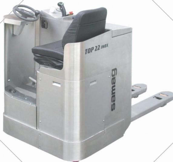
TOP INOX von Samag ist der Niederhubwagen aus Edelstahl (Palettenhubwagen) mit Fahrersitz mit außerordentlicher Einsatzflexibilität und hervorragendem Fahrkomfort. Der Rahmen ist zur Gänze aus Edelstahl gefertigt und für den Einsatz in Umgebungen bestimmt, in denen die Sauberkeit und Hygiene wesentlich sind und Korrosionsprobleme bestehen.
