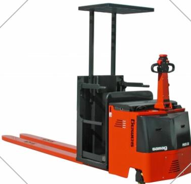
Pick 20 und Pick 22 von Samag sind die idealen Kommissionierer für die Beförderung der Waren in andere Abteilungen und für Kommissioniervorgänge auf niedriger und mittlerer Ebene. Um die Kommissioniervorgänge zu optimieren, können die Wagen mit der Hebeplattform (Serie PICK PE) ausgestattet werden, die eine Höhe von 1.180 mm vom Boden erreichen kann und dem Bediener somit die Entnahme von Waren in ungefähr 2.700 mm vom Boden ermöglicht.
