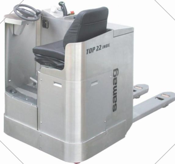
TOP INOX de Samag es el transportador de acero inoxidable (transpaleta) con operador sentado con extraordinaria versatilidad de uso y comodidad de conducción. El bastidor está fabricado completamente de acero inoxidable y está destinado para ser utilizado en ambientes donde la limpieza y la higiene son condiciones esenciales y donde existen problemas de corrosión.
